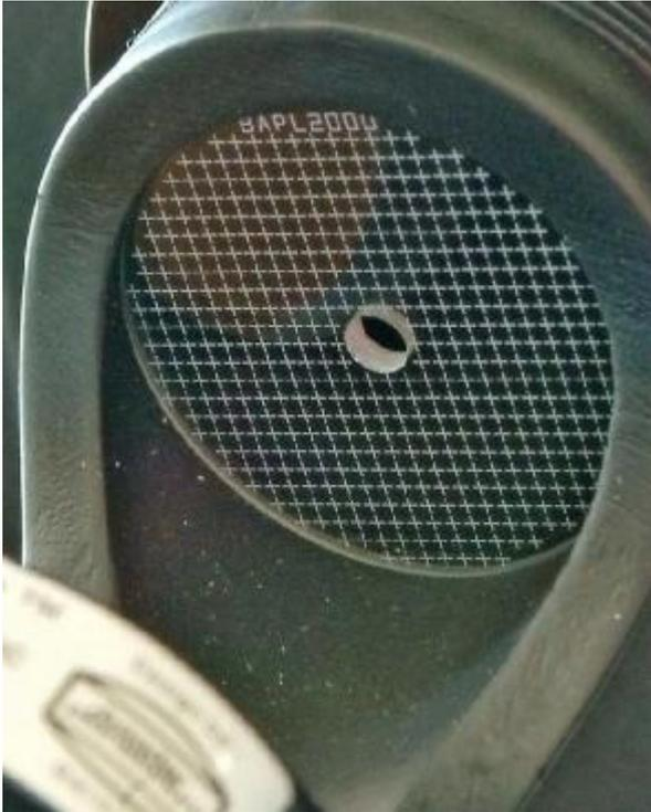
**Слева:** Светлая, прозрачная пластина с гравированными поперечными метками
