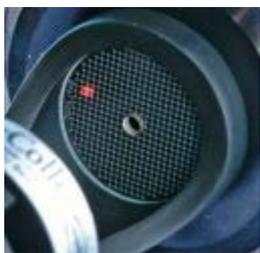
Если Вы видите это на прозрачной пластине, юстируйте (наклоняйте) главное зеркало так, чтобы лазерная точка на зеркале точно бы попала в центр круглой метки, тогда лазерный луч отразится в себя.
