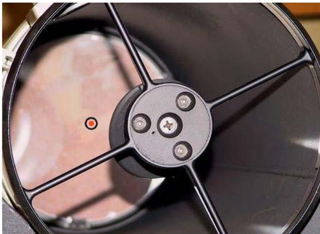
В большинстве конструкций телескопов вторичное зеркало регулируется тремя винтами, расположенными как изображено на рисунке (винты с внутренним шестигранником).
