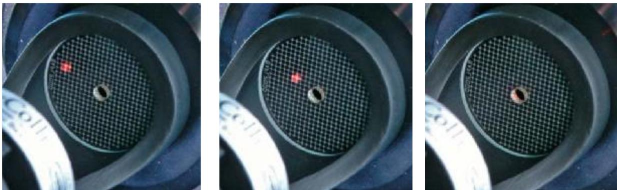
Наклоняйте главное зеркало с помощью винтов регулирования, пока лазерный луч не пройдет через отверстие в прозрачной пластине (и отразится в себя). Вот оно! Ваш телескоп отлично отколлимирован. Последняя проверка качества коллимации должна быть сделана по звезде (см. ниже).
